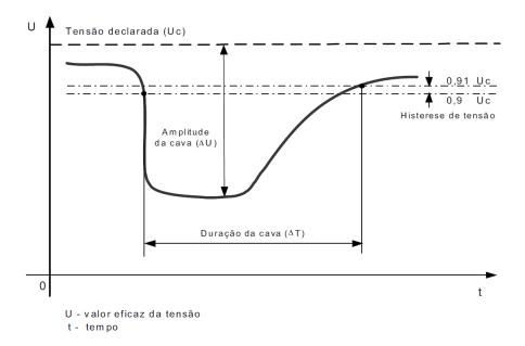
b) O início ocorre quando, num determinado ponto da rede, o valor eficaz da tensão de uma ou mais fases cai repentinamente para um valor situado entre 90% e 5% da tensão de referência deslizante U<sub>rd</sub> (valor eficaz da tensão existente imediatamente antes do início da cava) e termina quando a tensão retoma um valor acima dos 90% dessa tensão de referência acrescida de um valor de histerese (relatório técnico CEI 61000-2-8).
