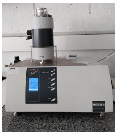
Figura 3.6: Equipamento utilizado para o TGA: Netzsch STA 449 F3 Jupiter.
