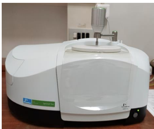
Figura 3.4: Equipamento utilizado para a análise FTIR, PerkinElmer - Spectrum Two.
