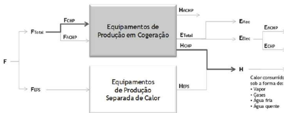
Figura 2 — Representação gráfica de uma Instalação de Cogeração com equipamentos de produção em cogeração (processo ou unidade de cogeração) e equipamentos de produção separada de calor e identificação das principais variáveis objeto de medição
