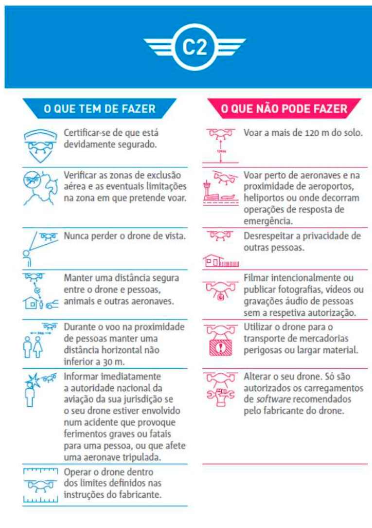
Figura 4 — Operação de uma aeronave não tripulada com uma marcação de conformidade de classe C2. 19
