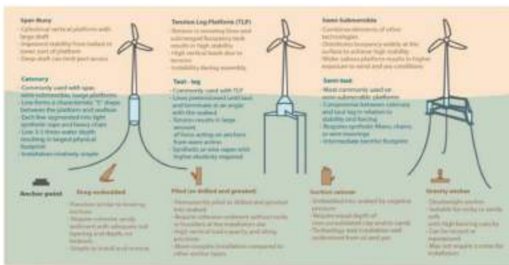
Figura 6C-2. Ilustração dos tipos de flutuadores, sistemas de amarração e de fundação. Fonte: Maxwell et al., 2022.
