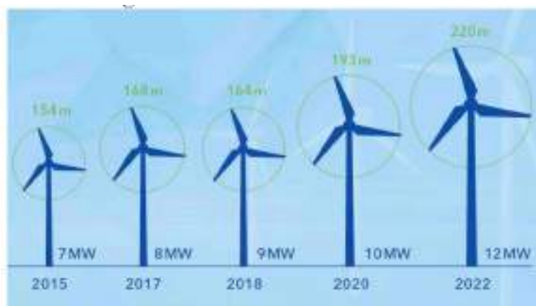
Figura 6C-4. Evolução do tamanho dos aerogeradores e das respetivas potências entre 2015 e 2022: Adaptado de DNV.
