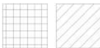
Figura 8 – Marcação de pavimentos e coberturas, respetivamente
