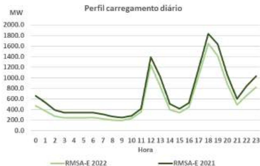
FIGURA 4 - PERFIL DE CARREGAMENTO VE CENÁRIO AMBIÇÃO 2030 PARA OS RMSA E 2022 E 2021 (60% "DIRECT RECHARGING" E 40% "VALLEY RECHARGING")
