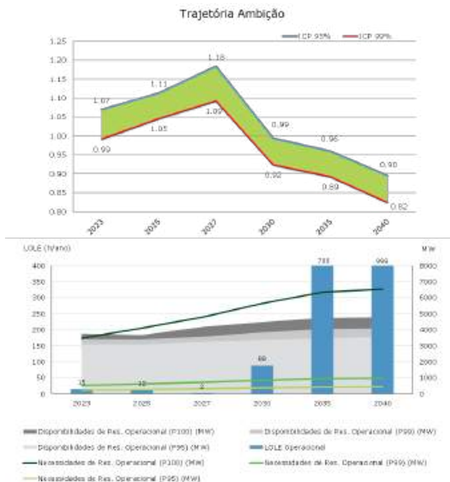
FIGURA 15: ICP, LOLE E IDENTIFICAÇÃO DE DISPONIBILIDADE E NECESSIDADE DE RESERVA OPERACIONAL – TRAJÉTÓRIA AMBIÇÃO
