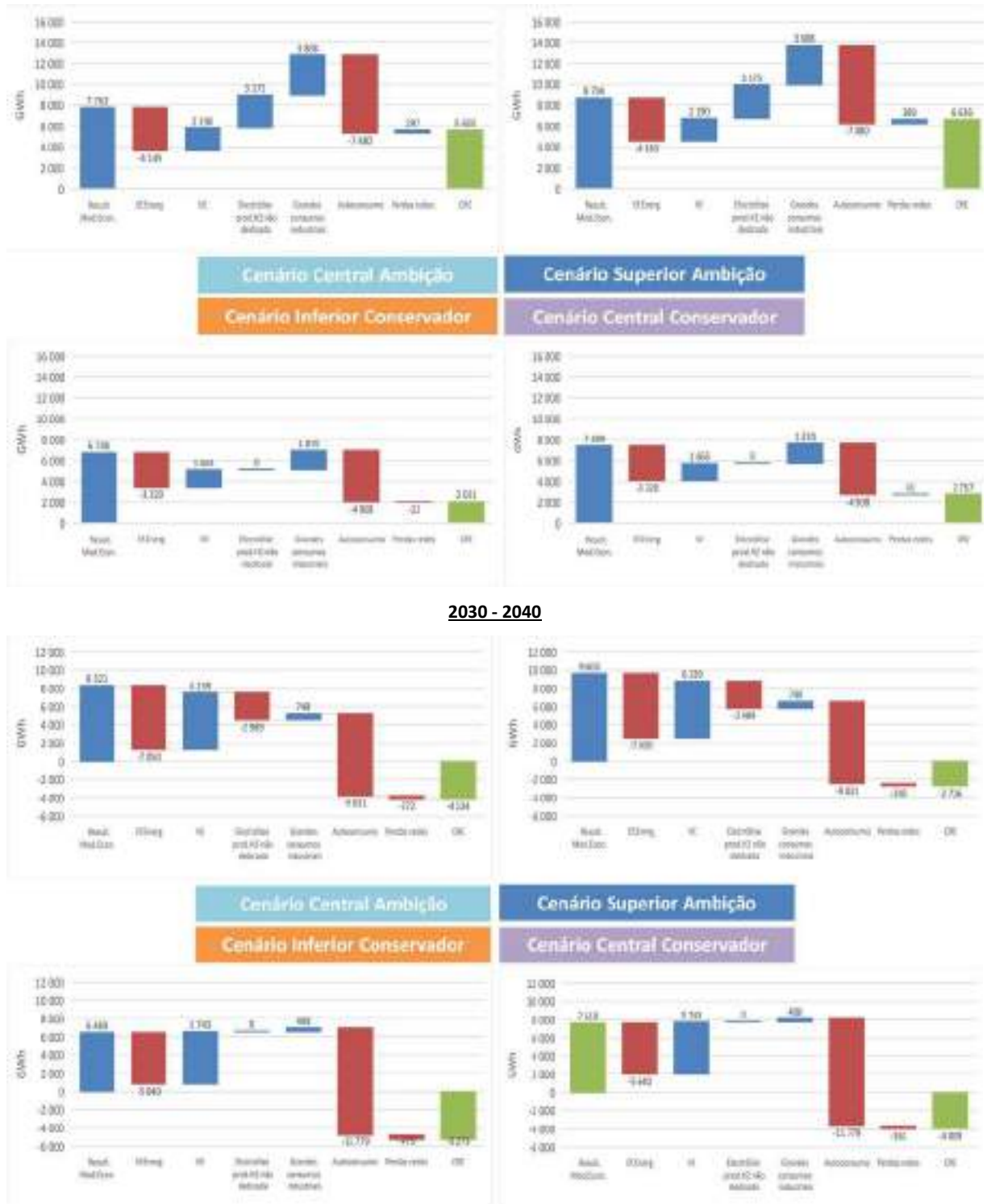
FIGURA 53 – EFEITO DOS DISTINTOS VETORES NA PREVISÃO DO COSUMO REFERIDO À PRODUÇÃO LÍQUIDA, EXCLUÍDO DA ENERGIA DEDICADA À PRODUÇÃO DE H 2 EM CIRCULAÇÃO NA RNT – CONTRIBUTOS EM CADA PERÍODO 2023 - 2030
